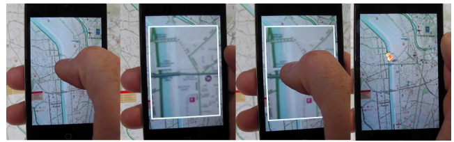
Figure 5: AR TapTap [11] : Placement précis de points d'intérêt sur une carte. La relation R1 est interrompue le temps de la création du point d'intérêt.
